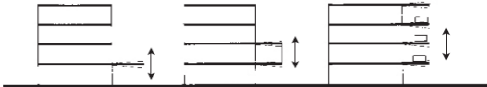
Figure I.15 : Oscillations verticales de porte-à-faux.
