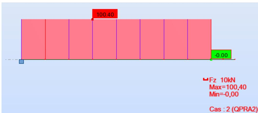
Fig. VII.15 : Diagramme des efforts tranchants dus a la surcharge concentrée.
