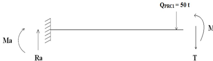
Fig. VII.17 : Surcharge d'équipage mobile.
