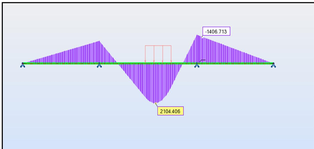
Fig (V.55): Diagramme des moments fléchissant dus à la surcharge D240.
