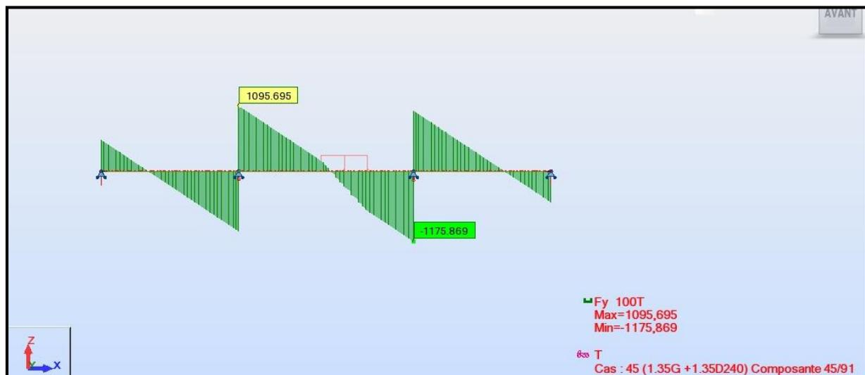
Fig (V.64): Diagramme des efforts tranchant sous ELU 3.
