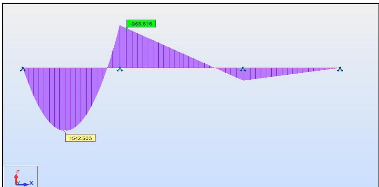
Fig (V.47): Diagramme des moments fléchissant dus à la surcharge A(L)(1).
