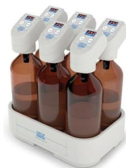
**Figure 5.9.** Dispositif de mesure de la DBO<sub>5</sub>
