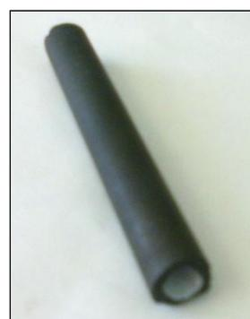
**Figure 5.8.** La membrane d’UF
