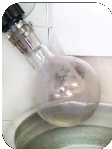
Figure 6.17. Elimination du solvant par évaporation
