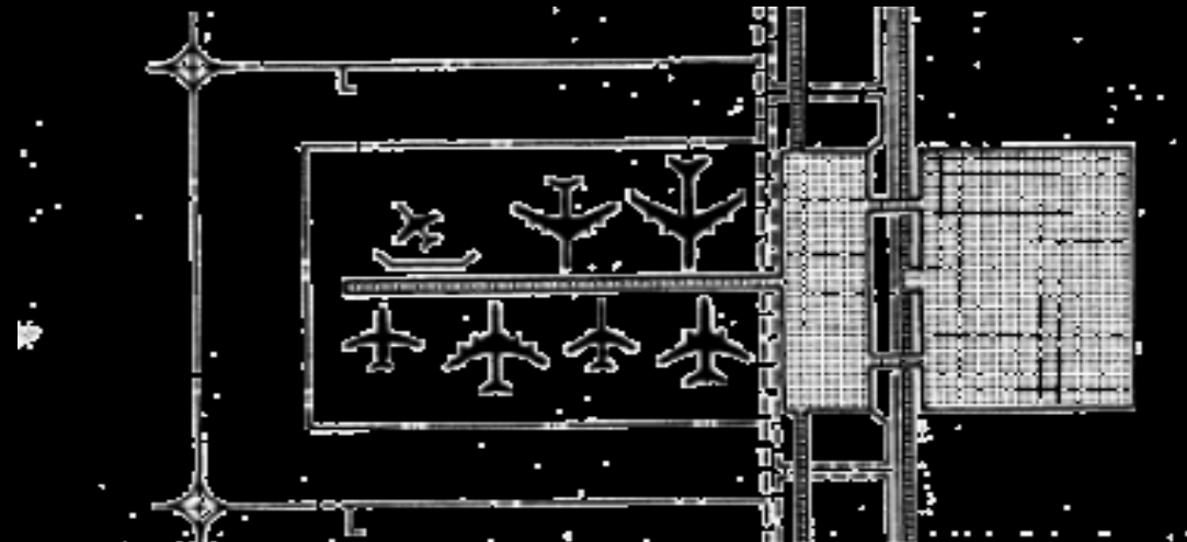
Fig45: configuration d'un aérogare galerie
