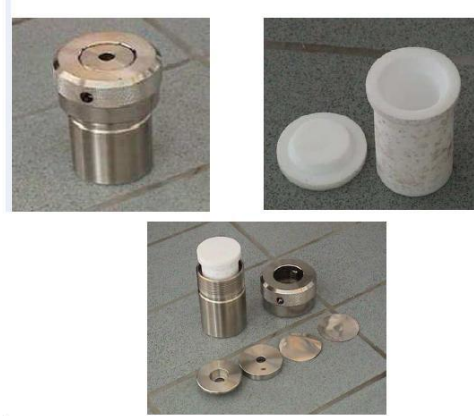
Figure II.5: Dispositif de l'autoclave utilisé dans la méthode hydrothermale
