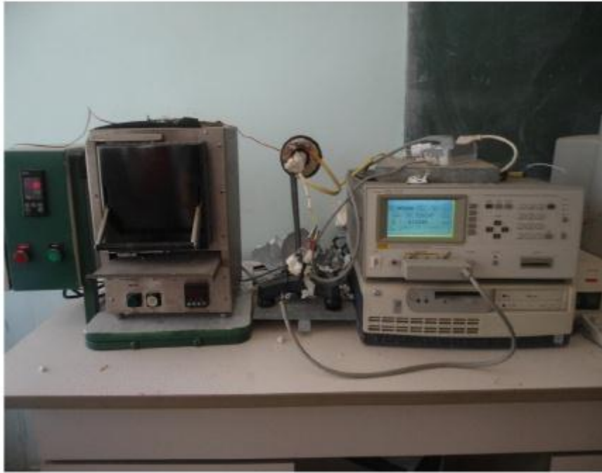
Figure II.16: Photo de l'appareil de mesures des propriétés diélectriques.
