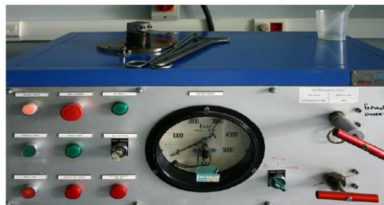
Figure II.8: Illustration et image de la presse isostatique
