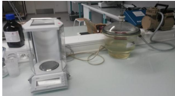
Figure II.13: Montage de mesure de densité par pesée hydrostatique
