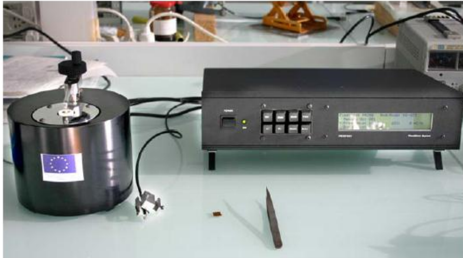
Figure II.20 : Piézomètre (Piezotest PM200)
