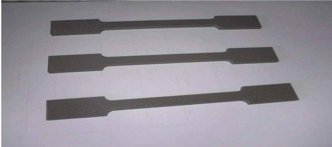
*Figure III.20. Eprouvette élaborée par 3D*
