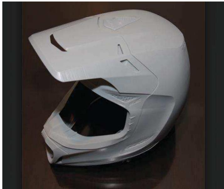
*Figure II.15. Objet imprimé en Polypropylène*
