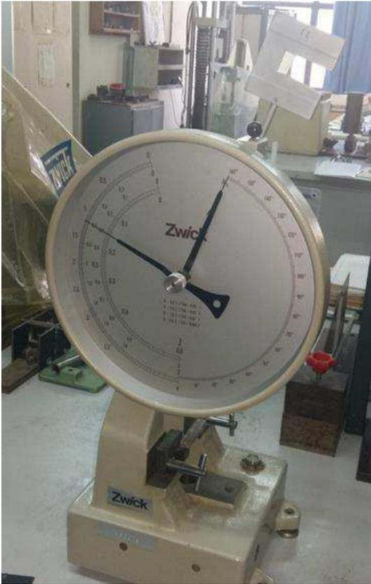
Figure III.28. Machine de résilience Zwick 5102
