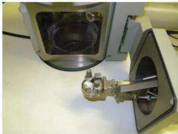
Figure III.15. La chambre dans laquelle on peut placer 4 objets.
