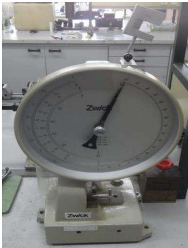
Figure .III.8. Machine d'essai de résilience (mouton pendule)
