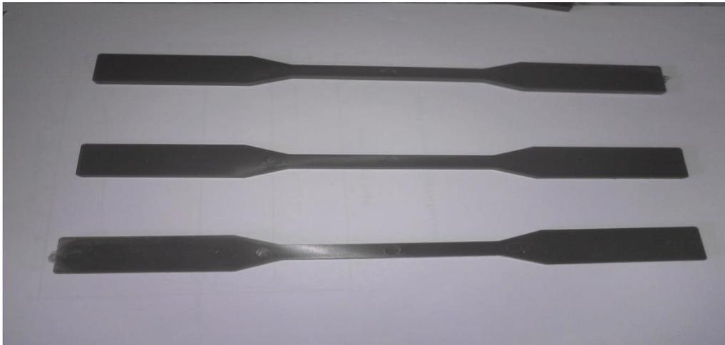
Figure III.19. Eprouvette élaborée par injection
