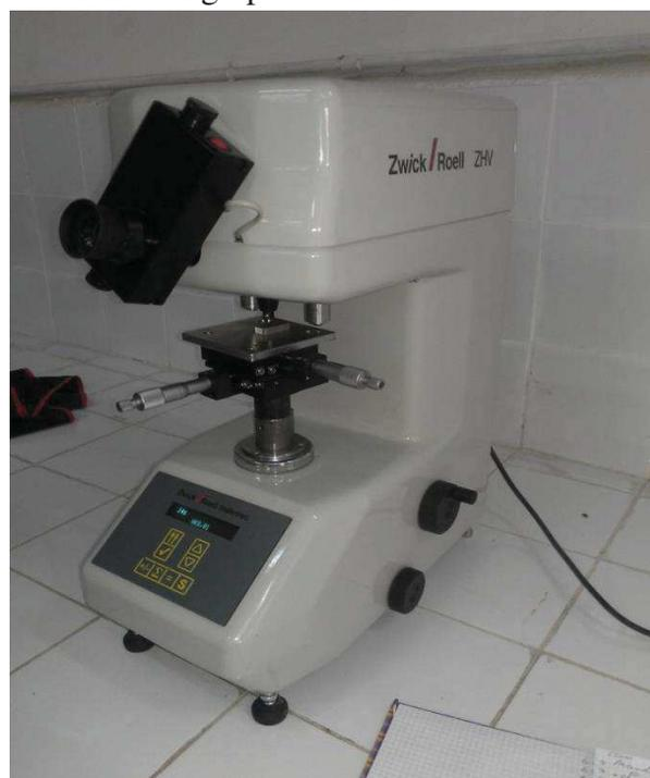
Figure III.29. Microduromètre
