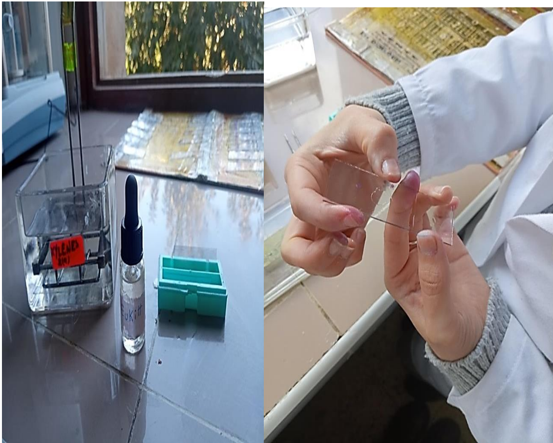
Figure 19 : A:Les lames dans le xylène et Eukitt B:Une lamelle fixé sur la lame avec Eukitt (Originale, 2025)
