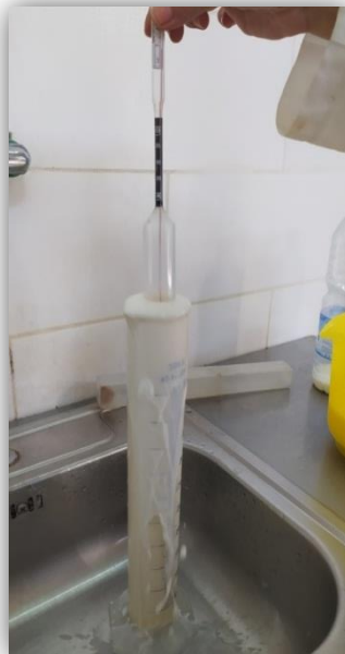
Figure n° 08 : Appareil utilisé pour la mesure de la densité (lactodensimètre).
