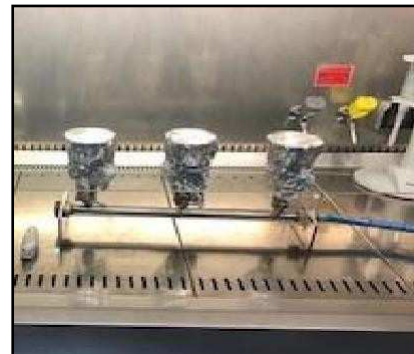
Rampe de filtration
