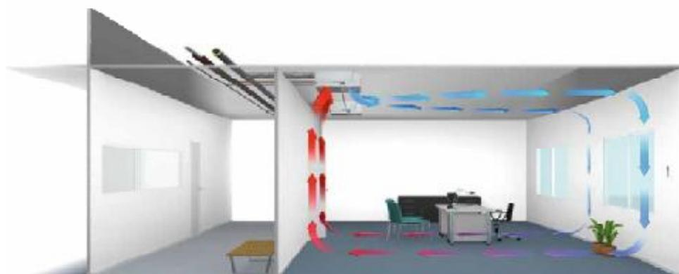
**Figure V.6 :** Exemple de diffusion par effet Coanda. [4]
