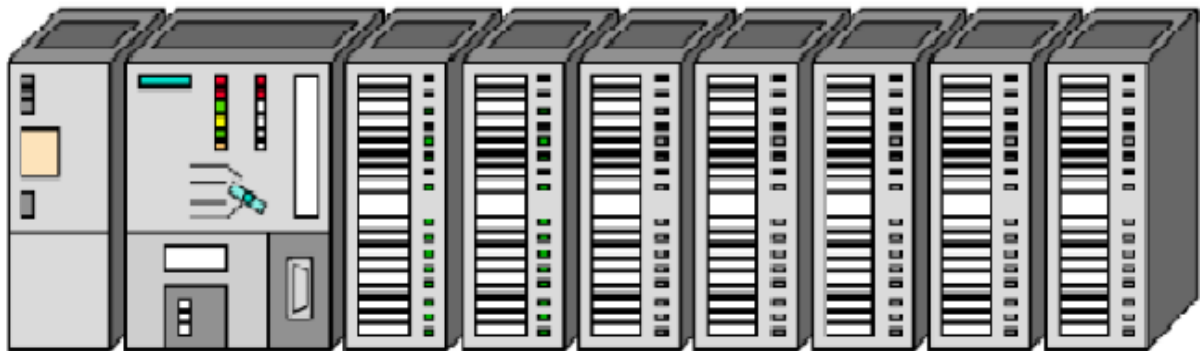
Figure IV.1 : Vue général de l'automate S7-300
