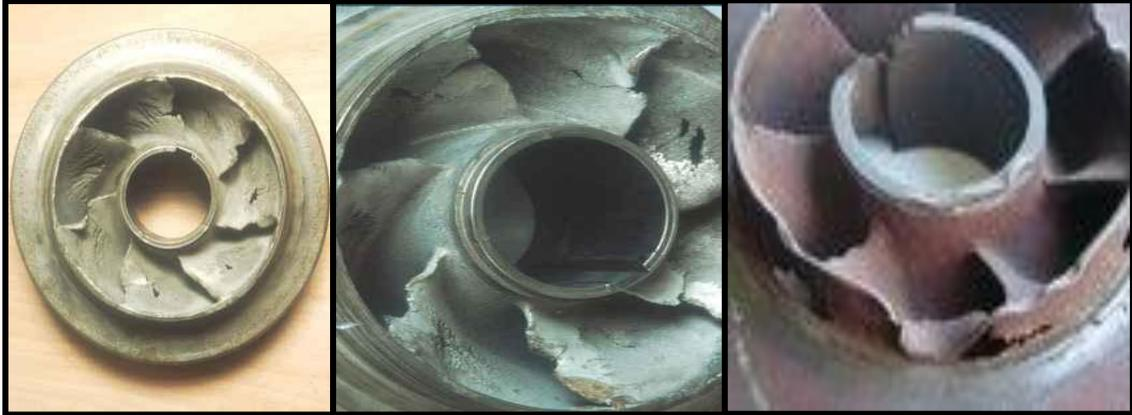
**Figure. 7.8 : Photos illustrant le phénomène de cavitation sur les aubes d'une pompe centrifuge**
