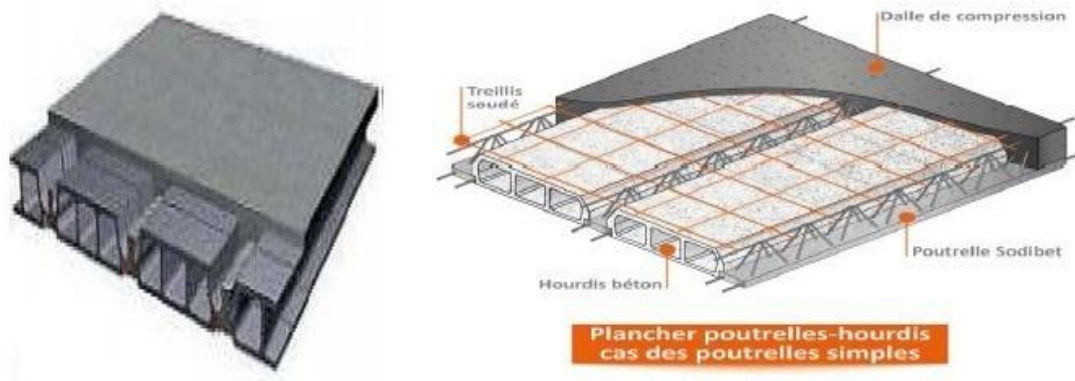
Fig.I.1 Schéma descriptif du plancher à corps creux
