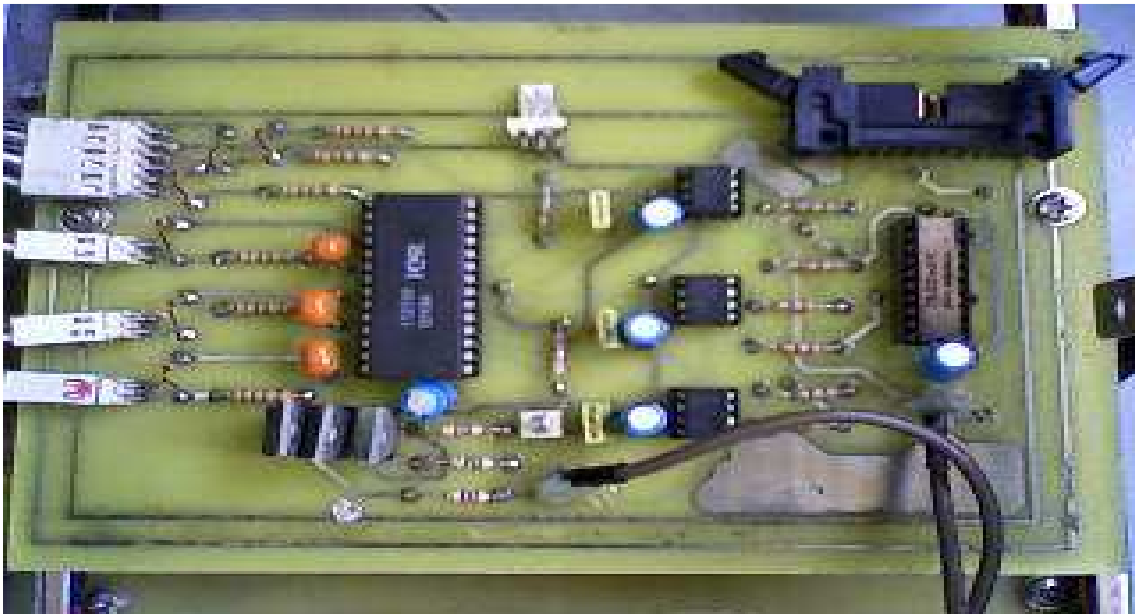
Photo (IV) : Le circuit imprimé de la commande rapprochée
