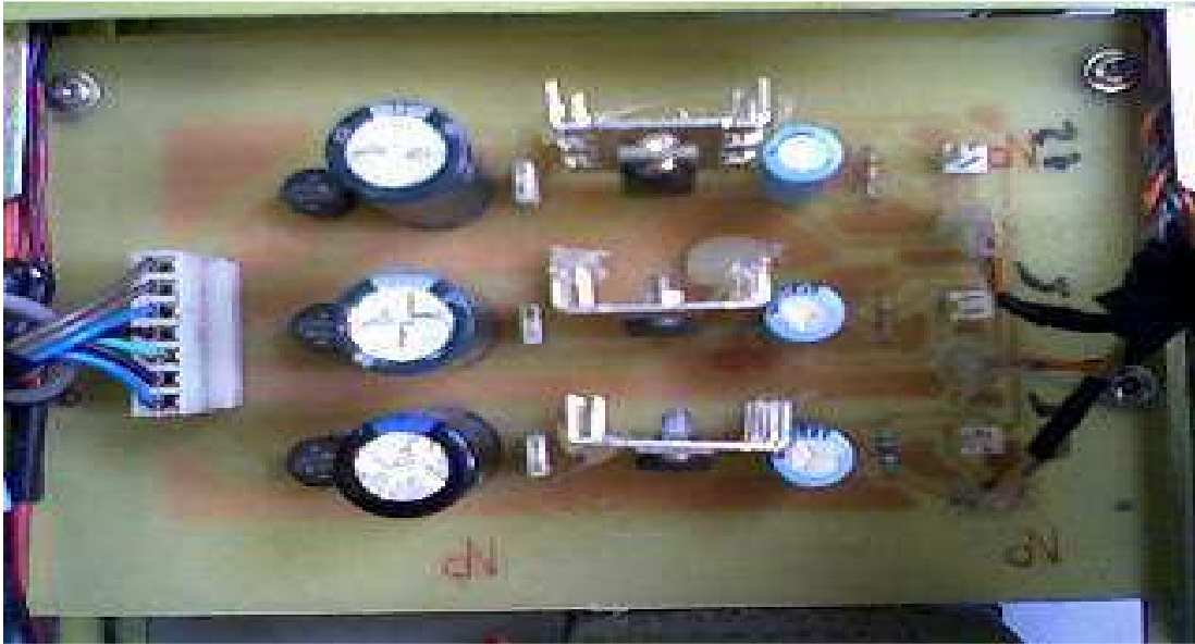
Photo (VI) : Le circuit imprimé des alimentations basse tension.
