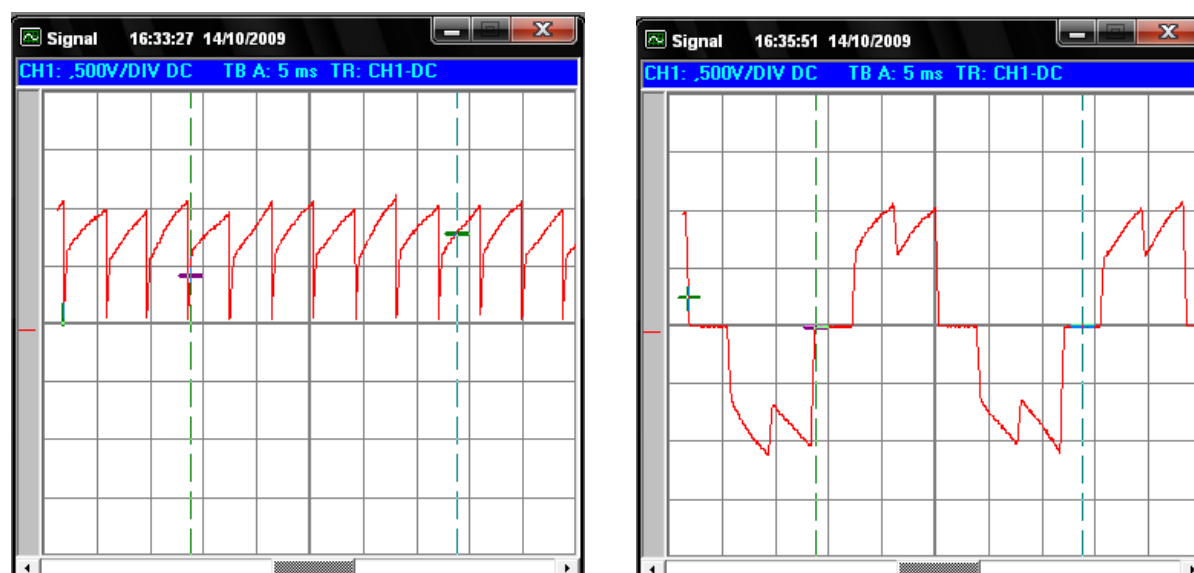
Figure (IV-14) : la variation du courant continu d'entrée et celle d'une phase de la BDCM en fonction du temps et une vitesse de 1280tr/min.
