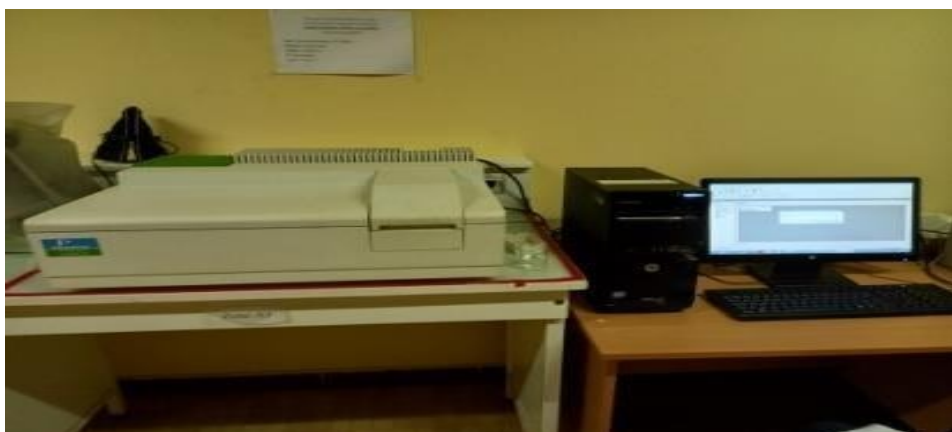
Figure 1 : Spectrophotomètre UV-Visible relié un ordinateur pour le traitement des données
