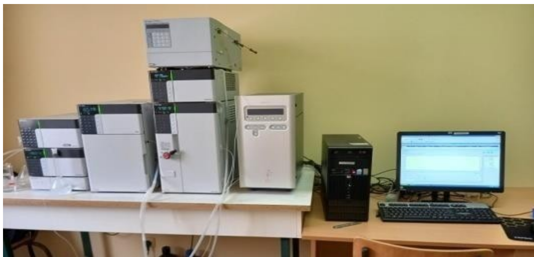
Figure 8 : Différents composants d'un appareil HPLC relié à un ordinateur pour le traitement des données
