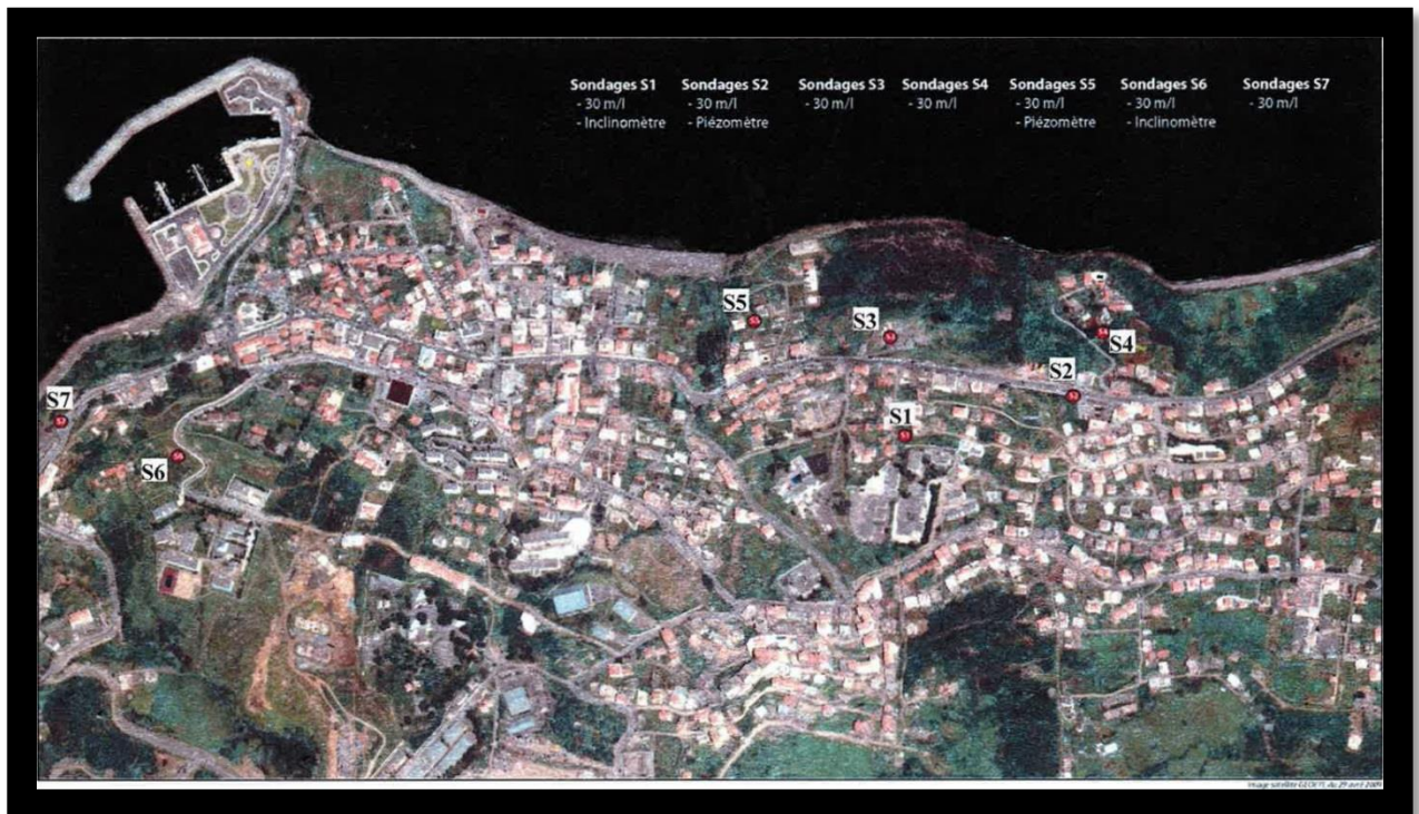
Figure III-11: localisation des sondages carottés (source ANTEA-TTi Hydroenvironnement)
