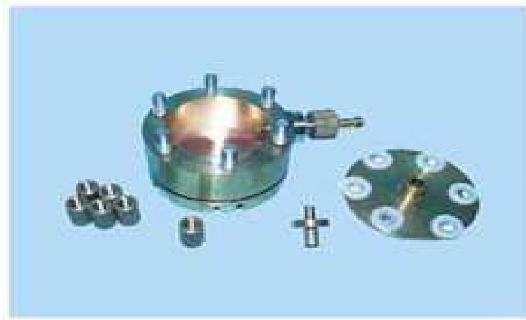
Figure2- le dispositif de mesure de la cavité cylindrique.
