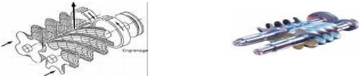
**Fig (I-3) :** les vis d'un compresseur à vis
