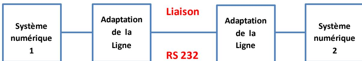
Le PIC utilise les niveaux 0V/5V pour définir respectivement l'état numérique 0 et 1. La norme RS 232 quant à elle définit des niveaux de +12V/-12V, d'où la nécessité d'un circuit chargé de convertir les niveaux des signaux entre PIC et PC.
