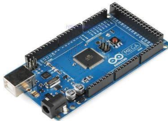
Figure I.15 : Carte Arduino MEGA
