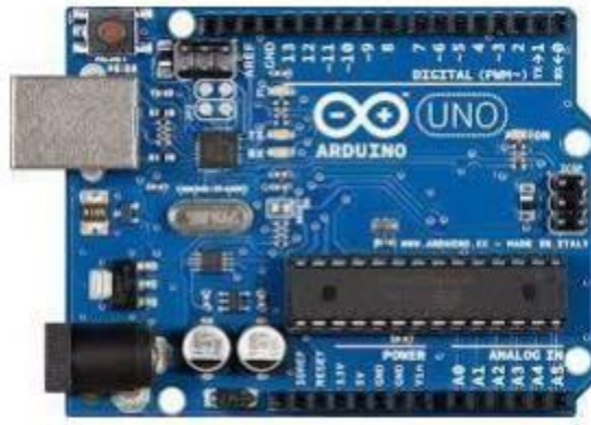
Figure I.14 : Carte Arduino UNO
