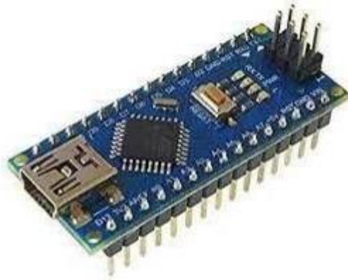
Figure I.16 : Carte Arduino NANO
