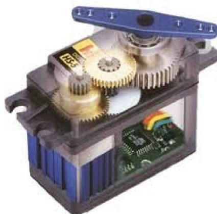
**Figure II.16 : Un servomoteur**
