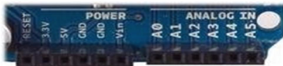
Ces pattes sont réservées à la mesure de signaux analogiques et permettent de convertir une tension analogique  $V_E$  de 0 à 5 V en une valeur numérique.
