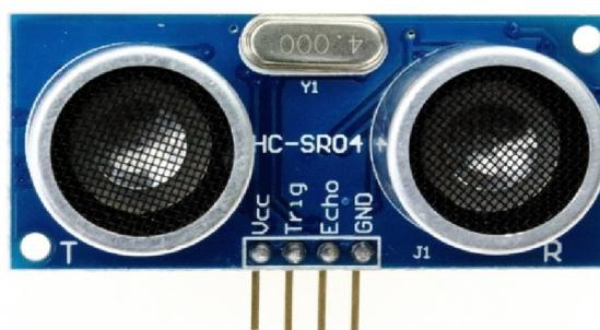
Figure II.4: Capteur à ultrason HC-SR04
