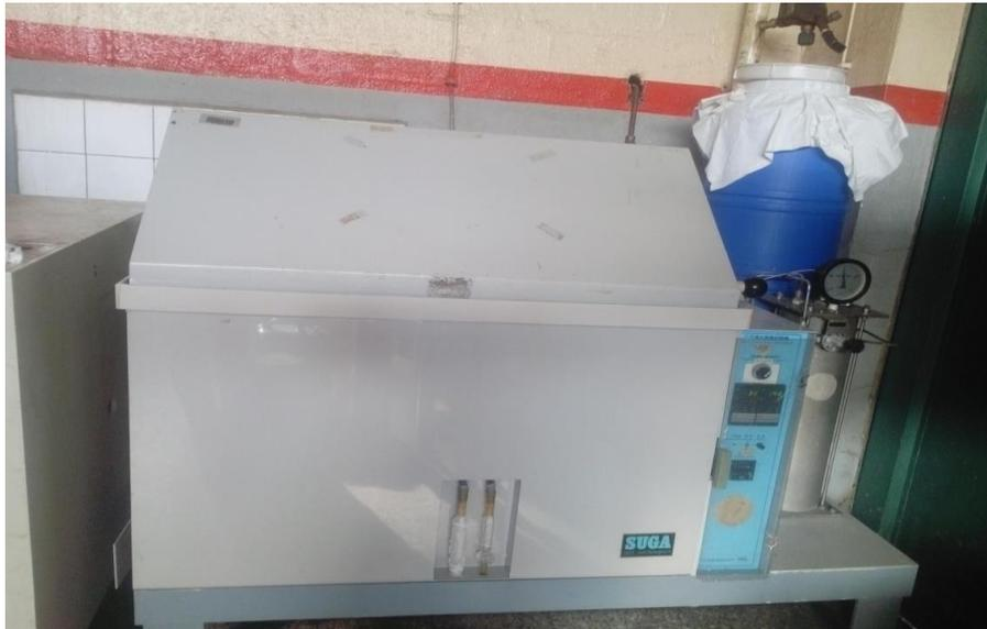
**Figure 4.16 :** Armoire du Brouillard salin
