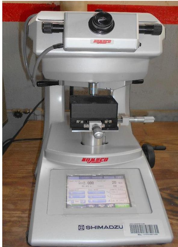
**Figure 4.6 :** Machine de mesure de la micro dureté modèle SHIMADZU
