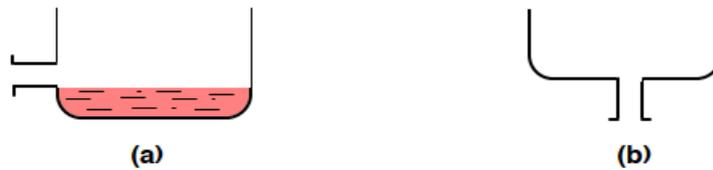
Figure 2.14 : Prévention par la forme du récipient (a) : mauvais. (b) : correct [26]
