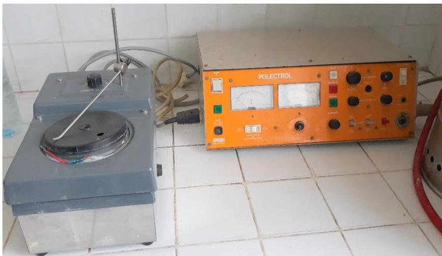
**Figure 4.2 :** Dispositif de l'attaque électrolytique STRUERS POLECTROL
