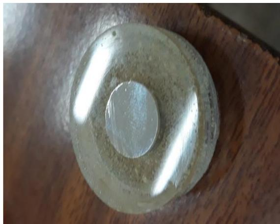
**Figure 4.8 :** Exemple d'un échantillon après enrobage à froid et polissage
