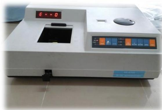
**Figure 27.** Spectrophotomètre UV 9200 (Photo originelle, 2015).
