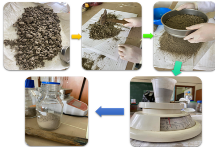
Figure 07 : Étape de préparation de sol
