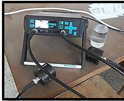
Figure II.5. : Appareil de test ultrasonique Pundit-Lab
