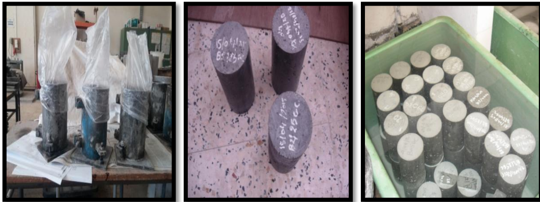
Figure II.4 confection des éprouvettes, protection, marquage et immersion dans l'eau.
