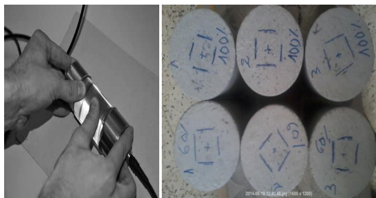
Figure II.6.: calibrage de l'appareil, marquage des points d'essai
