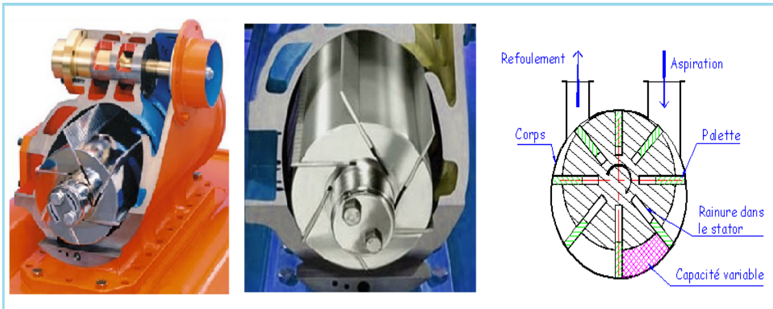
FIGURE 3.6 – Compresseur rotatif à palettes.
