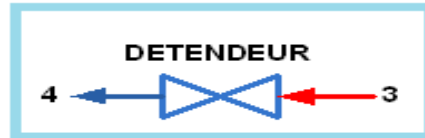
FIGURE 3.37 – Schématisation d'un détendeur.
