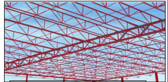
Figure182 : modélisation 3D poutre en treillis Source : l'auteur
