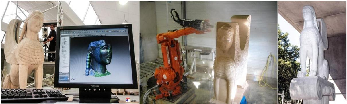
**Figure III.3** Prototypage du Sphinx des Naxiens du sanctuaire de Delphes taillé en marbre de Carrare à l'aide d'un robot tailleur de pierre
