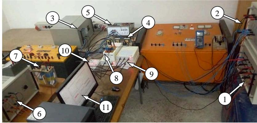
**Figure 5.27** : Photo du banc d'essai : 1) transformateur d'isolement, 2) résistances de déséquilibre, 3) résistances du filtre  $RL$ , 4) inductances du filtre  $RL$ , 5) onduleur triphasé, 6) résistance en série avec la source de tension continu d'alimentation, 7) source de tension continu, 8) capteurs de courants, 9) capteurs de tension, 10) connecteur entrée/sortie de la carte dSPACE et 11) PC-Pentium + carte dSPACE + ControlDesk
