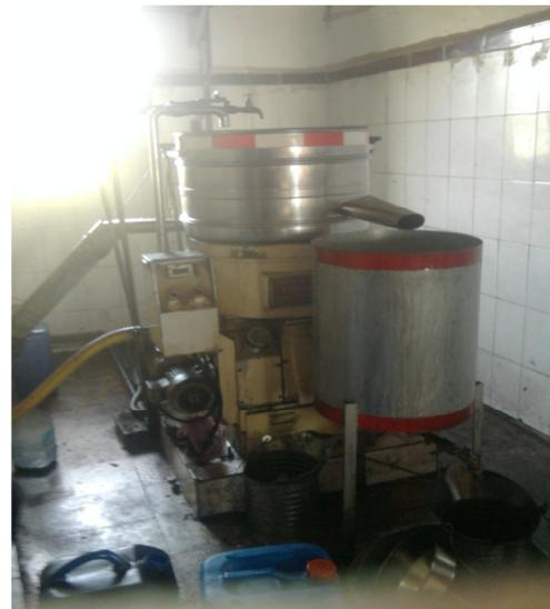
**Figure 12** : Centrifugeuse verticale a deux phases (originale Timizart, 2015).
