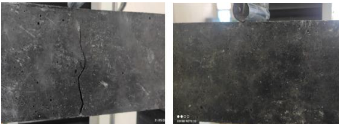
Figure III-6: éprouvette après écrasement( vue de près sur coté).
