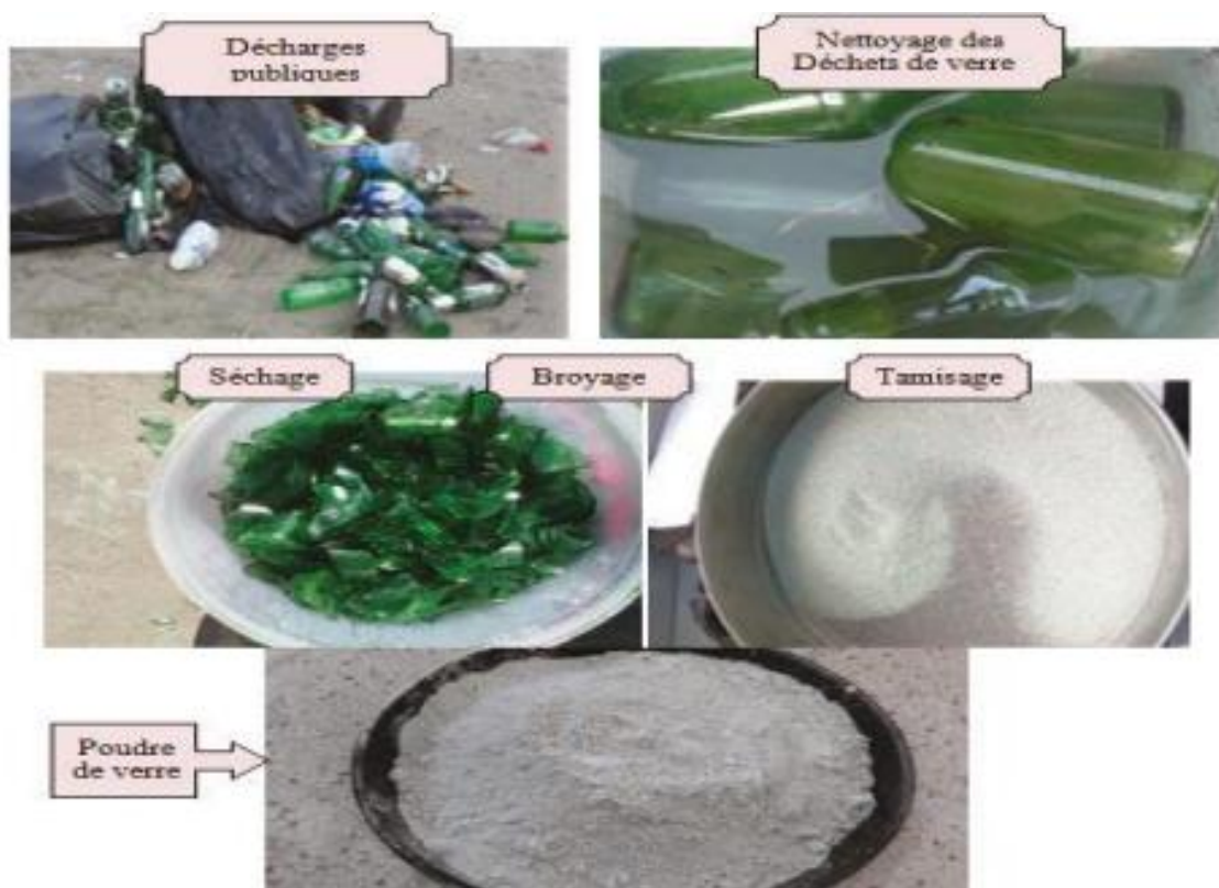
Figure I-4 : Transformation des déchets de verre en poudre de verre. [5]
