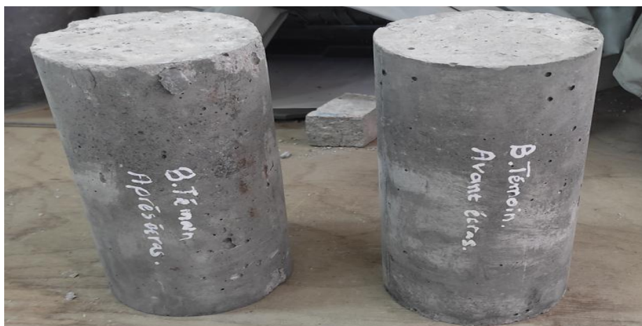
Figure III-8: éprouvette après écrasement.
