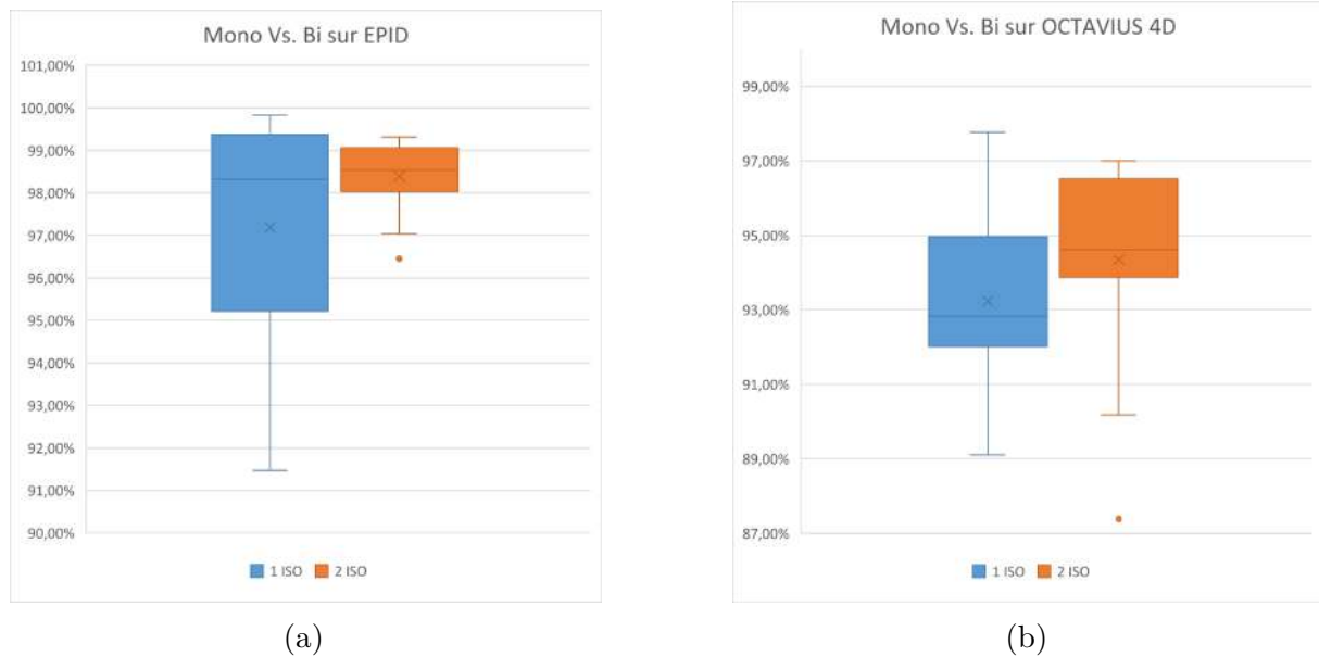
FIGURE 3.4 – Comparaison des scores gamma (en pourcentage %) entre les plans mono-isocentriques (1ISO) et bi-isocentriques (2ISO) mesurés par l'EPID (a) et l'OCTAVIUS 4D (b).
