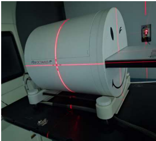
(a) Alignement des lasers de la salle avec les repères du fantôme lors de son positionnement sur la table de traitement.
