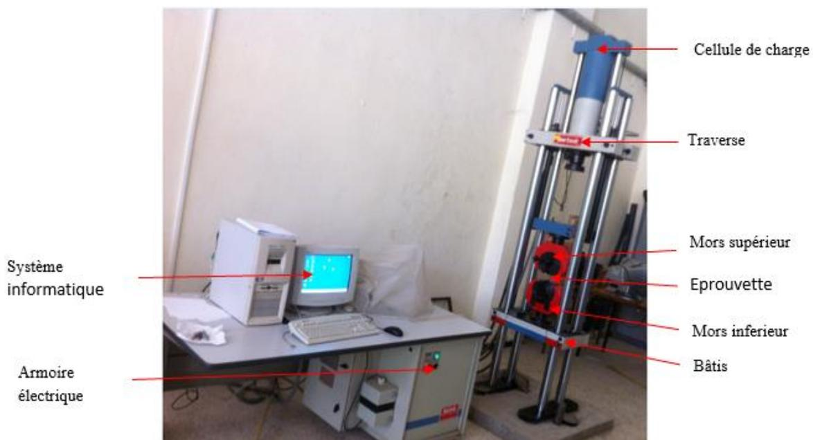
**Figure II.9** : Machine d'essai de traction
