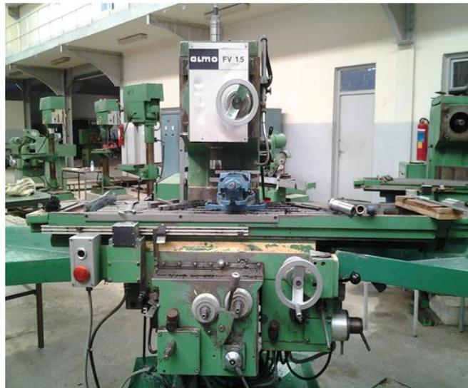
**Figure II.4** : Fraiseuse Verticale
