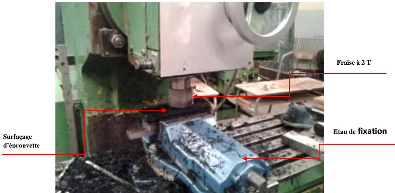
**Figure II.6** : Surfaçage d'éprouvette de pehd100
