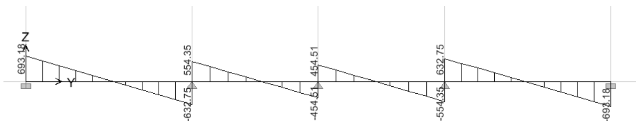
Figure 9.7 : Diagrammes des moments fléchissant aux KNm a ELU
