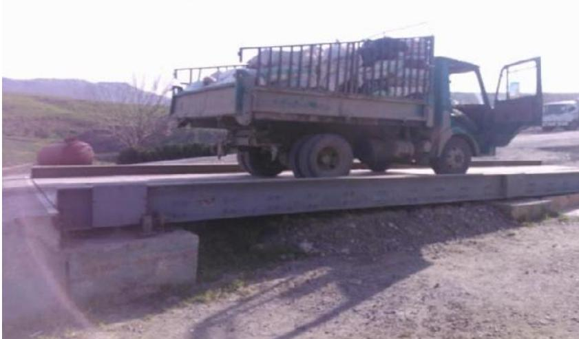
Figure 11 : Pont de bascule (Photo originale, 2016)
