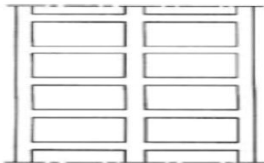
Figure II.1 : les ossatures en portiques [9].
