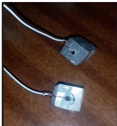
Figure IV.37: Echantillon découpé et connecté à un fil en cuivre.
