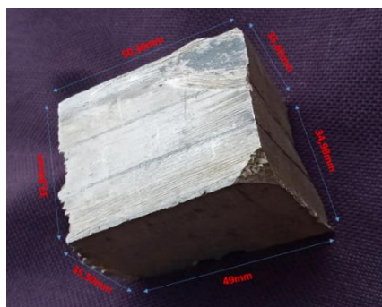
Figure IV.42 : Dimensions du bloc du magnésium.
