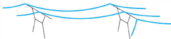
Figure (III.5) : Rupture d'un conducteur. [1]
