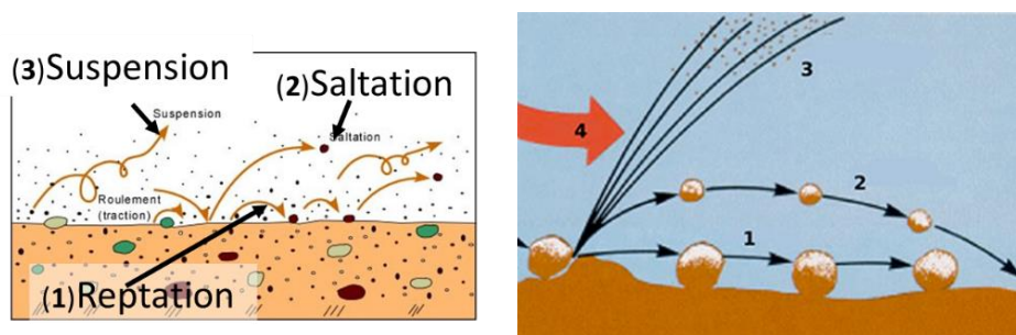
Figure 28: les Trois mécanismes principaux de l'érosion éolienne
