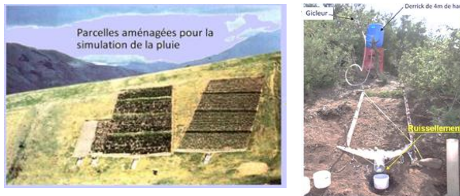
Figure 19. Parcelles expérimentales pour l'étude des effets érosifs via les pluies simulées.
