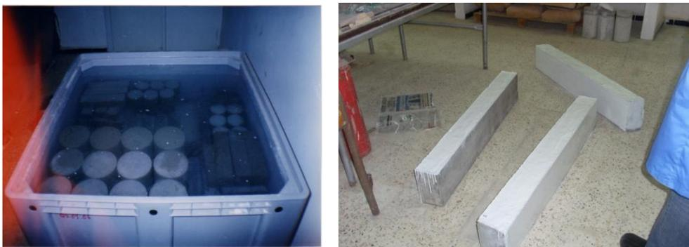
Figure V. 10: Conservation des éprouvettes pour 28 j avant écrasement.
