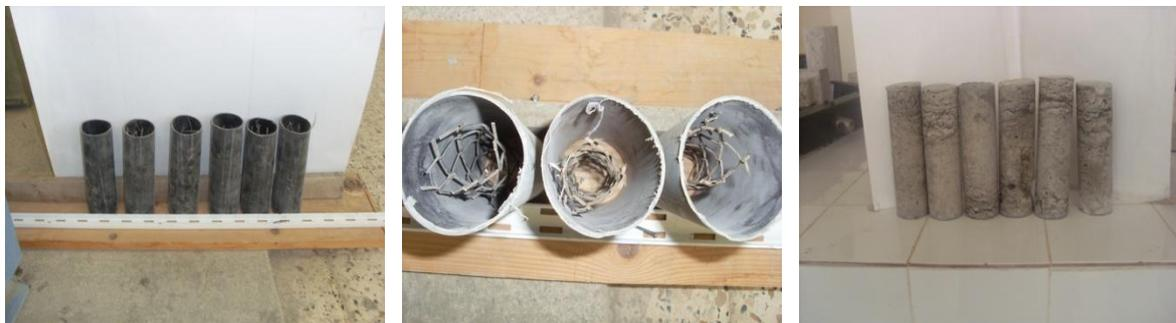
Figure V. 9: Confection, Moulage et Démoulage des bielles de béton confiné.
