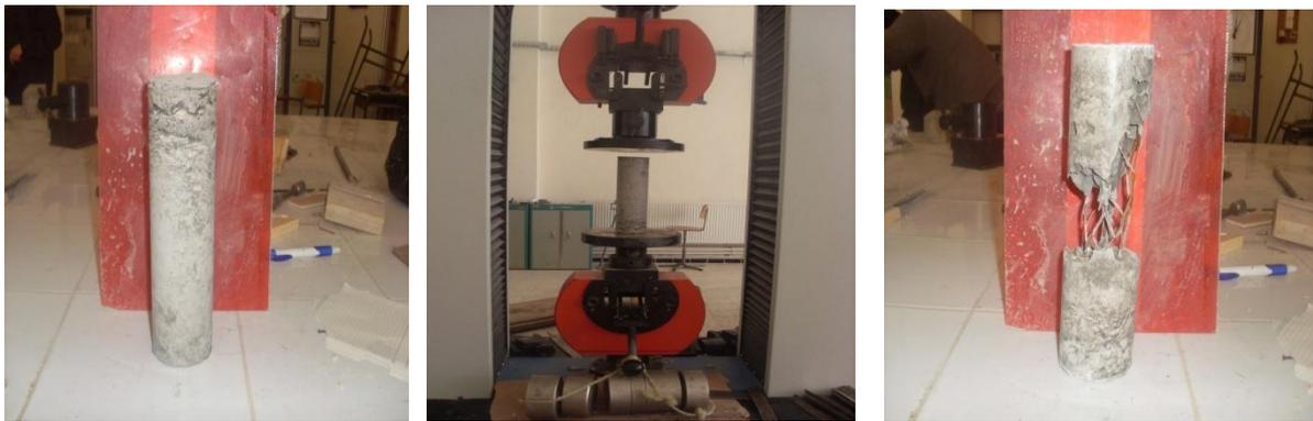
Figure V.15: Bielle de béton confiné sous effort de compression.
