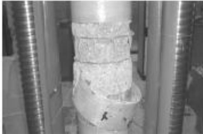
Figure III. 9: Rupture de colonne partiellement enveloppés [51].
