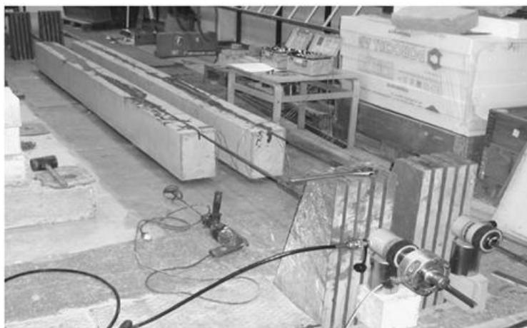
Figure I. 10: Essai de précontrainte dans un laboratoire à l'université de Lulea [8].
