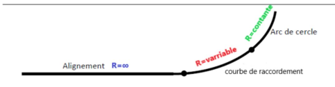
Figure 1: Eléments géométriques de tracé en plan.
