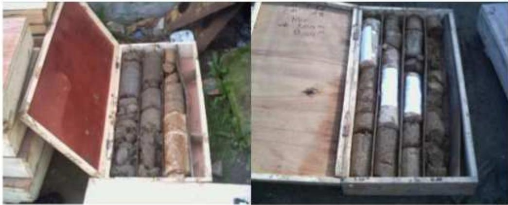
Figure 2: photos du sondage carotté (source rapport géotechnique)
