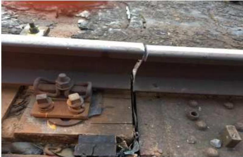
Figure 18: cas d'un rail rompu.
