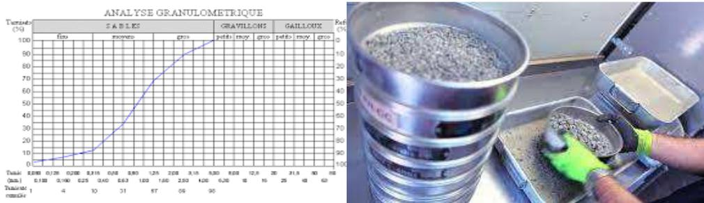
Figure 3: essai granulométrique (essai laboratoire)
