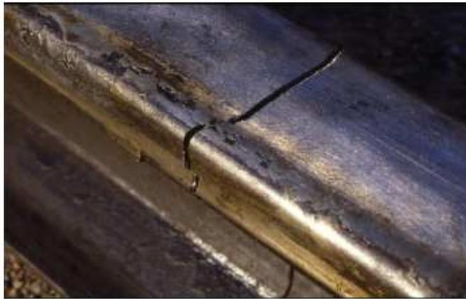
*Figure 16: Cas d'un rail fissuré.*
