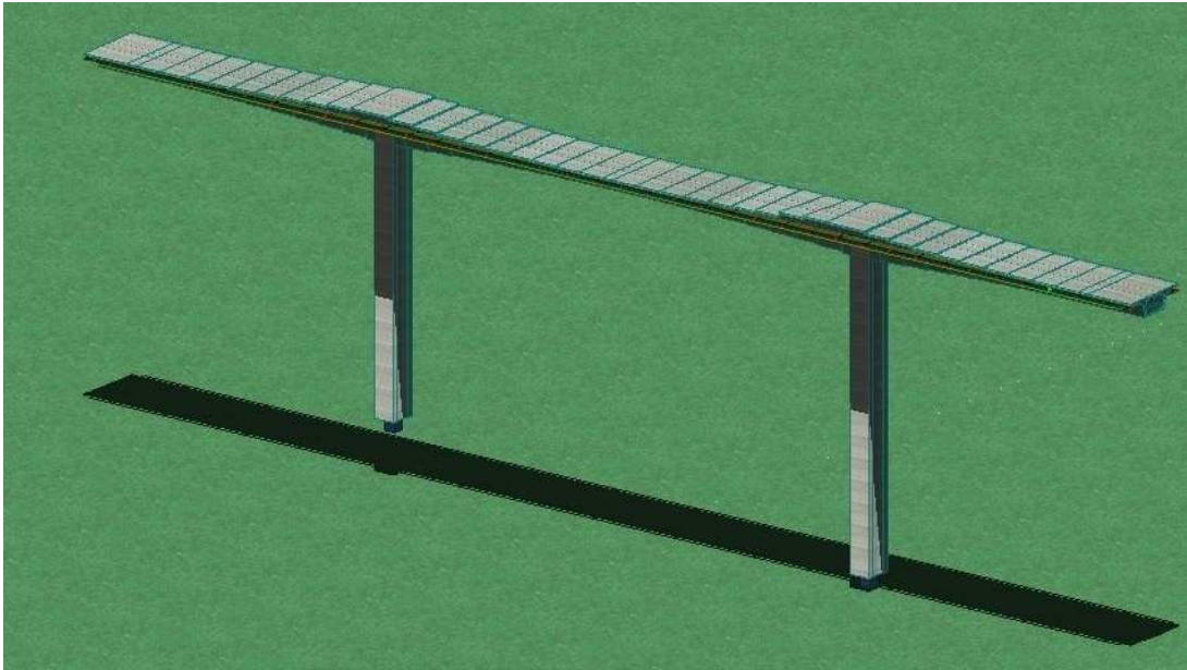
Fig.V.8. Modélisation du tablier.
