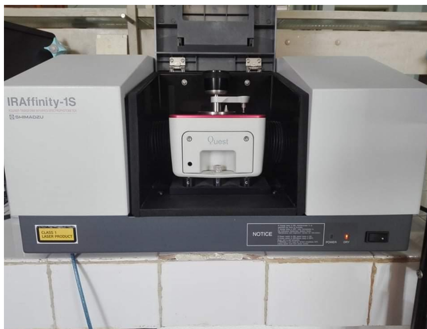
Figure II-6 : Photographie de l'appareil infrarouge.
