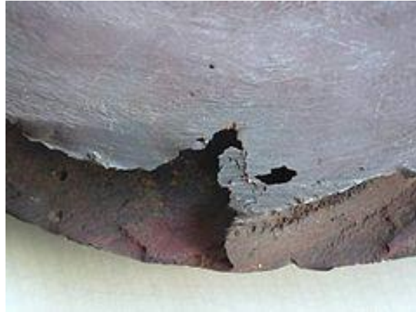
Figure I-5: Usure par Erosion
