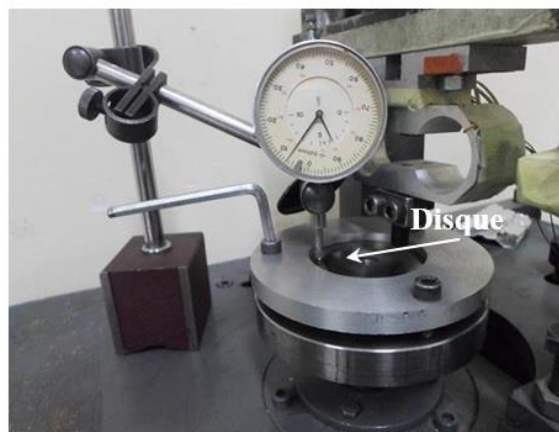
Figure III-3: Réglage de la planéité du disque
