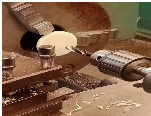
Figure III-15: Opération du perçage sur les disques
