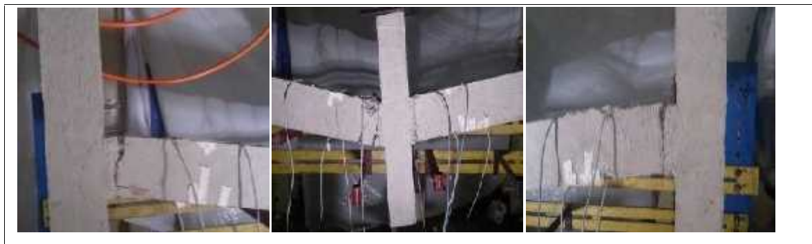
Figure II.13 Schéma de défaillance de la connexion monolithique
