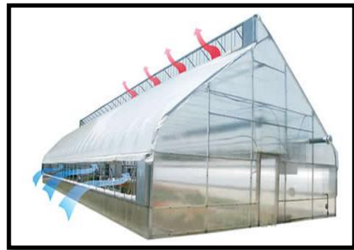
Figure 168: schéma représentatif de la ventilation d'une serre Source : info@sahgh.com
