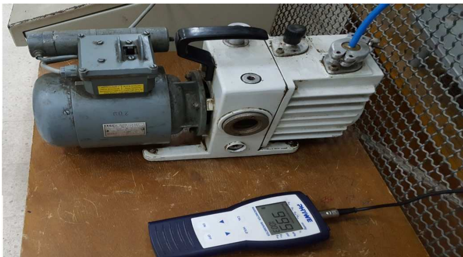
Figure III.5 Pompe à vide et dispositif de mesure de la pression
