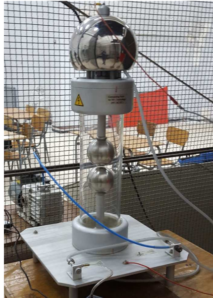
Figure III.2 Tube à décharge
