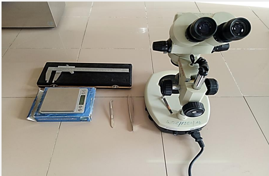
Figure 26: Matériels utilisés au laboratoire (loupe binoculaire, balance et pied à coulisse) pour l'étude expérimentale) (Photo originale, 2019).
