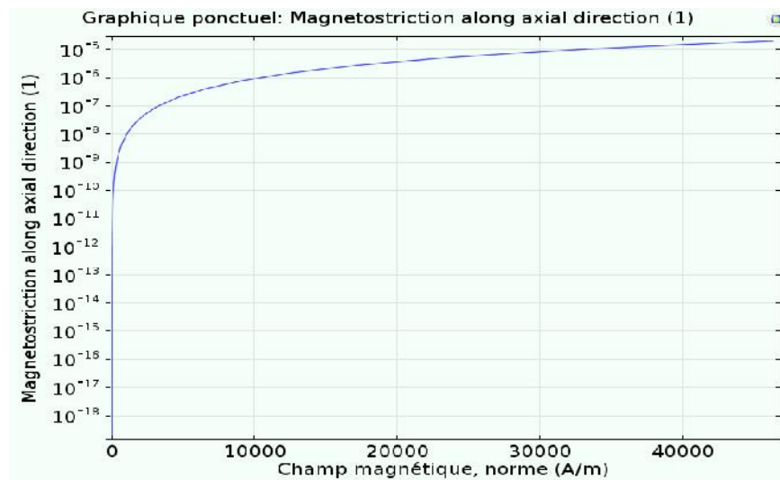
Figure 7a: La proportionnalité du champ magnétique et la magnétostriction.
